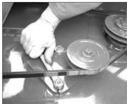
Lossande av pivåbult vid remskivans bas
