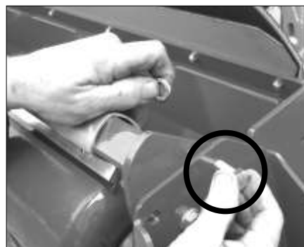
Montering av rullskrapa med övre bultar (bakre rulle visas)
