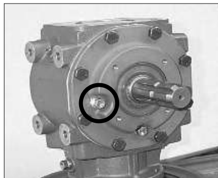
Växellådans oljenivåplugg (säkerhetskydd avlägsnat för tydlighetens skull)
