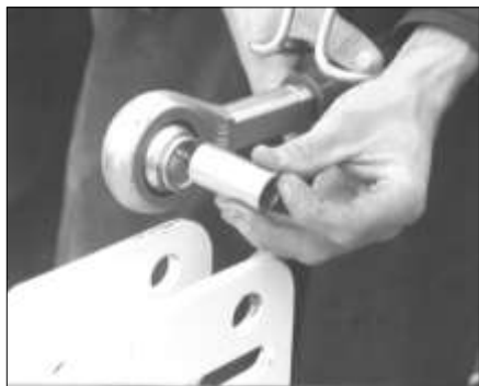
Montering av hylsadapter (medföljer ej) till topplänkssprinten vid användning av en traktor med Kategori 2-länksystem
