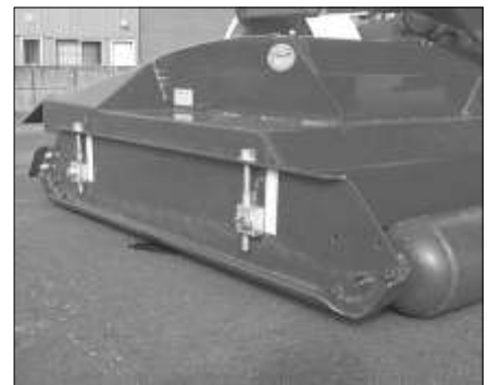
Typisk uppsättning rullar visandes höjdjusterare
