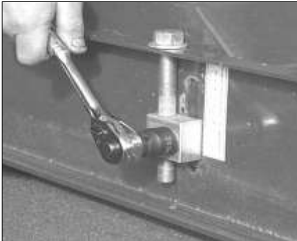
Lossning av sidokanalernas fästbultar
