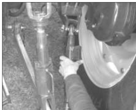
Justering av krängningshämmare (typexempel)
