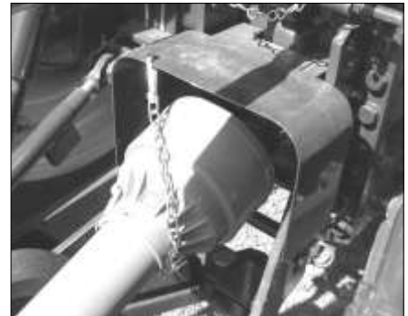
Koppling av säkerhetskedjor till traktor (typexempel)
