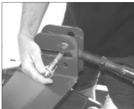
När skåroarna används, montera medföljande brickor på utsidan av bygeln
