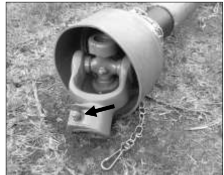
Snabbkoppling där den fjäderbelastade sprinten visas
