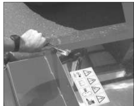
Lossande av självlåsande muttrar på kåpans främre kant
