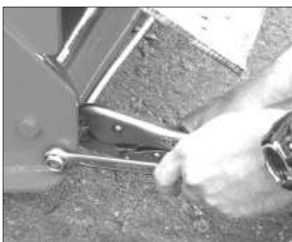
Hållandes änden av rullskrapans justerare med självlåsande tång medan låsmutter dras åt med skruvnyckel
