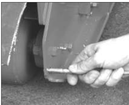
Passering av rullskrapa genom hål i rullfäste . . .
