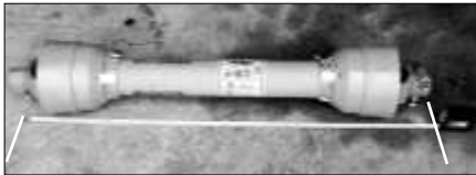
Mätning av Dimension "B" mellan drivaxelns låsspringar med axeln fullständigt ihoppressad
