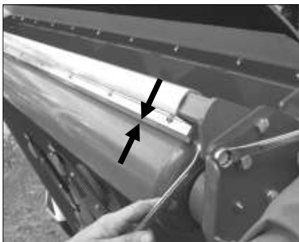
Justering av rullskrapan så att den precis går fritt från rullen
