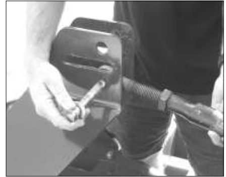
Montering av topplänken i fasta hål på mittstycket
