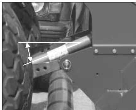
Kontrollera drivaxelns vinkel vid klipparens sida
