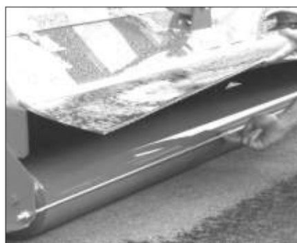
Kontroll av rullskrapans spänning
