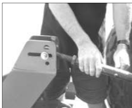
Justering av topplänken så att länksprinten är centrerad i skåran
