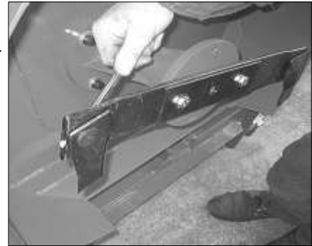
Lossande av knivbultsmutter
