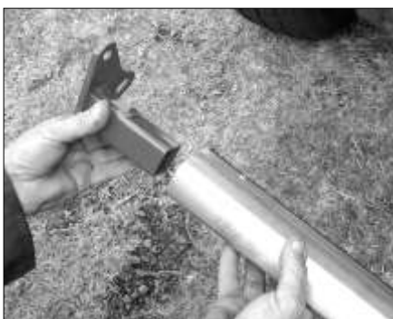
Montering av fästen till rullskrapornas profil
