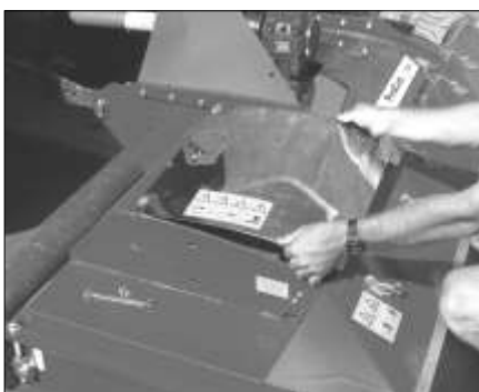
Avlägsnande av kåpa från klipparen
