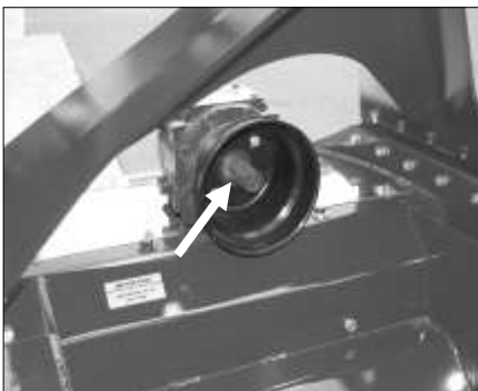
Växellådans ingående axel visande de splines & det spår där du finner snabbkopplingssprinten
