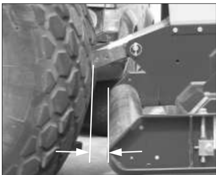
Kontroll av spelrummet mellan klippaggregatet och traktordäcken med klipparen fullt upplyft
