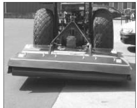
Lyft av klipparen för att se om den lyfts jämnt. Bilden visar att vänster sida är för låg.
