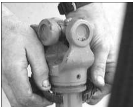
Avlägsnande av plastlagrets krage från spåren i kardanknutens gaffel (typexempel)
