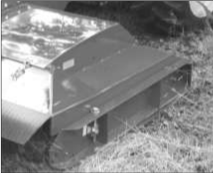
Sidokanal för enskild bakre rulle med en höjjusterare
