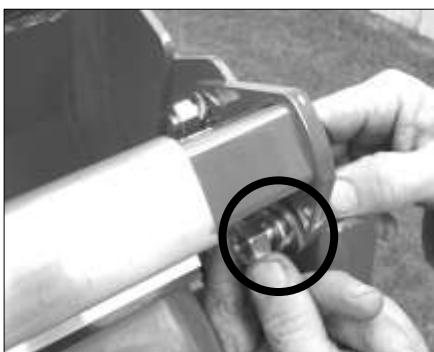
Montering av nedre bultar med hjälp av tjocka plana brickor, fjäderbrickor & muttrar
