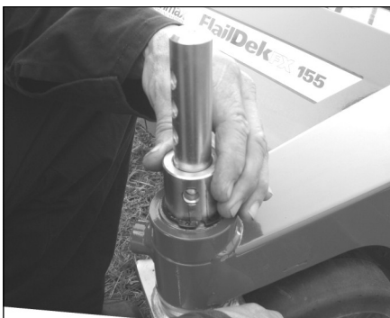
Vridning av hylsans 90 grader för att passa in alternativa hål
