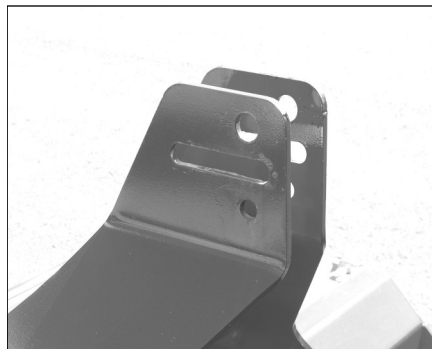
Den övre länkens kopplingspunkter på mittstycket
