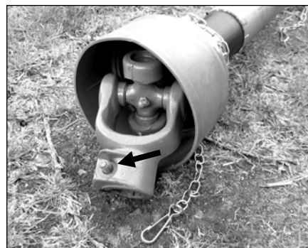
Snabbkoppling där den fjäderbelastade sprinten visas
