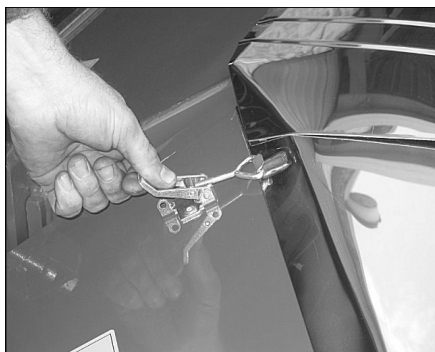
Lossande av excenterlås
