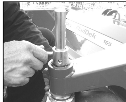
Fasthållning av hjul medan bulten avlägsnas från länkhjulens höjjustering
