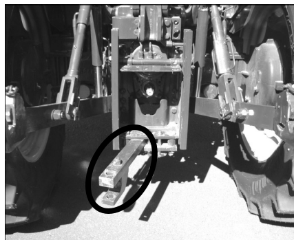
Dragstången korrekt monterad åt ena sidan
