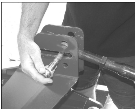
När skåron används, montera medföljande brickor på utsidan av bygel
