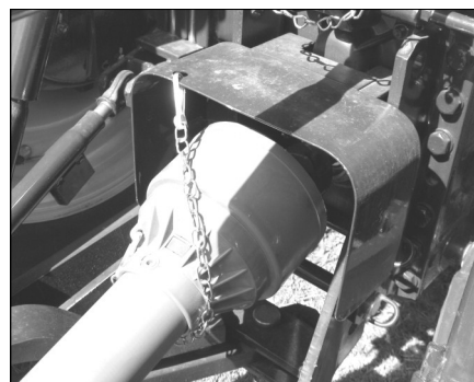
Koppling av säkerhetskedjor till traktor (typexempel)
