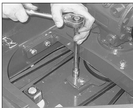
Lossande av bultar på remstyrningen som angränsar till växellådans remskiva
