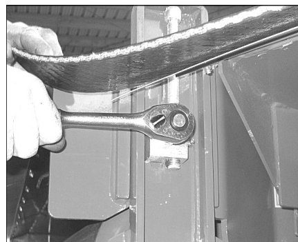
Lossande av klämbult på bakre
