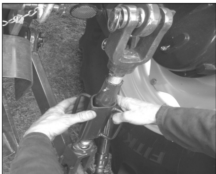
Användning av domkraft på traktors länksystem för att nivellera klipparen (typexempel)
