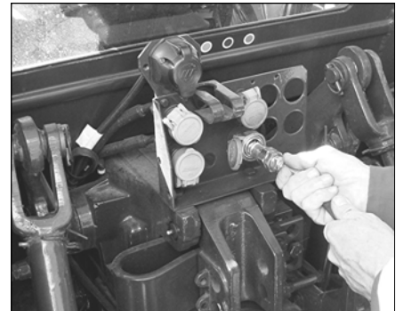
Anslutning av hydraulslangar till traktorns hydraulkopplingar (typexempel)
