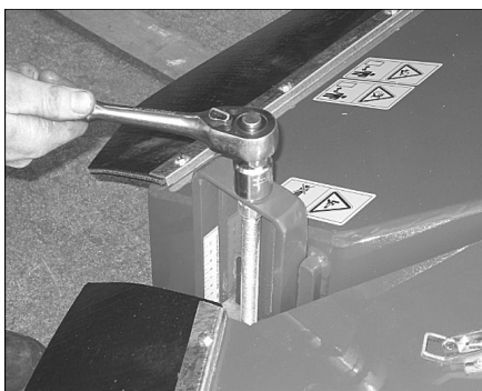
Vridning av höjjusteringsskruv för att ändra klipphöjd.
