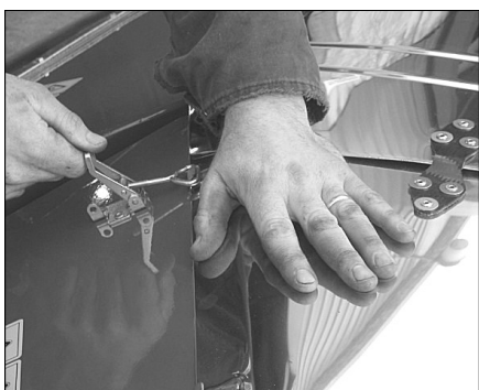
Fasthållning av skyddskåpan vid hantering av excenterlåset
