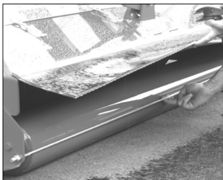
Kontroll av rullskrapans spänning
