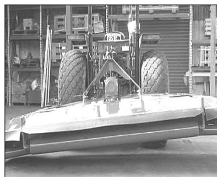
Lyft av klipparen på trepunktslyften för att se att den lyfts jämnt. Bilden visar att vänster sida är för låg.
