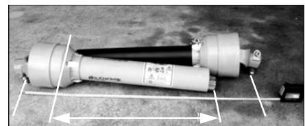
Kontroll av drivaxelns överlappning. Ställ in låssprintarna enligt Dimension "A". Pilarna visar att överlappningen måste vara minst 100mm (4").
