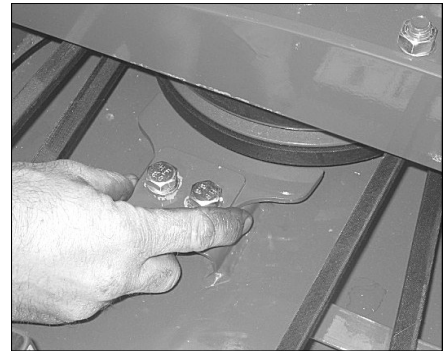
Placering av remstyrningen så nära växellådans remskiva som möjligt
