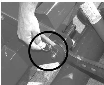
Montering av ringsprint på länksystemets monteringsprint
