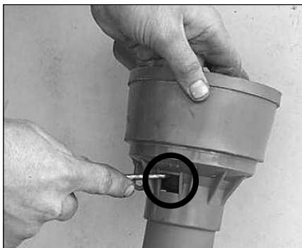
Nedpressning av konan och användning av skruvmejsel för att lossa på spärrnar vid konans bas
