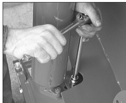
De inre justeringsklämbultarna på vingarna är tillgängliga från undersidan h
