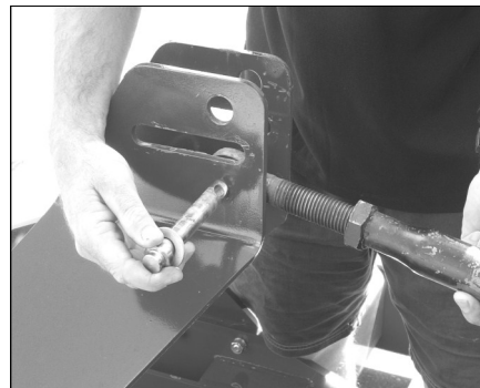
Montering av topplänken i fasta hål på bygeln
