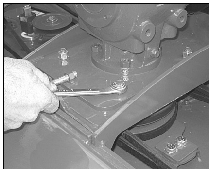
Lossande av muttrar som håller växellådan på plats
