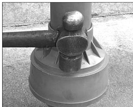
Försiktig knackning av kona över varje lagerspärr med hammare medan röret pressat nedåt
