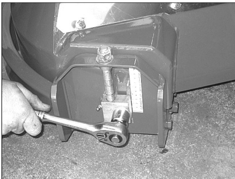
Lossande av klämbulten på vingarnas främre bubbelrulle
