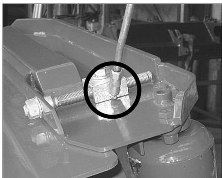
Smörjning av vingändens höjdjustering
