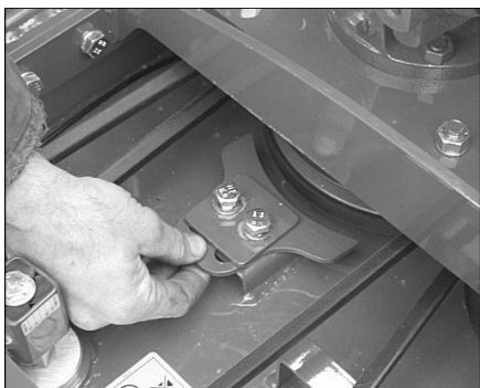
Skjutning av remstyrningen bort från växellådans remskiva
