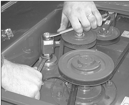
Fasthållning av styrrullens bas med en 20mm skruvnyckel samtidigt som bult
