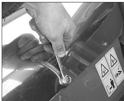
Lossande av låsmutter för att frigöra den främre delen av skyddskåpan
