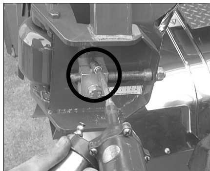
Smörjning av främre rullens höjdjustering
