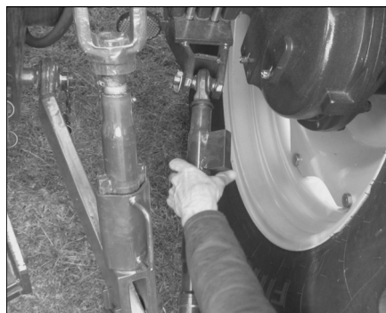
Justering av krängningshämmare
