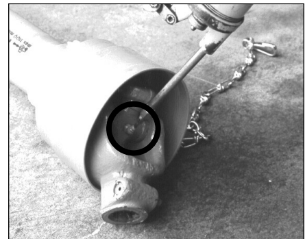
Smörjning av kardanknutar
