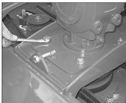
Lossande av muttrar på fyra bultar som håller växellådan på plats
