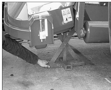
Placering av ställningar under klippaggregatet för att förhindra oavsiktlig nedsänkning
