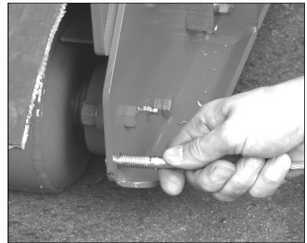
Matning av rullskrapan genom hålet i rullfästet. . .
