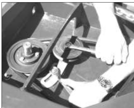
Tryck appliceras på spännrullens bult medan monteringsbulten lossas & dras åt igen
