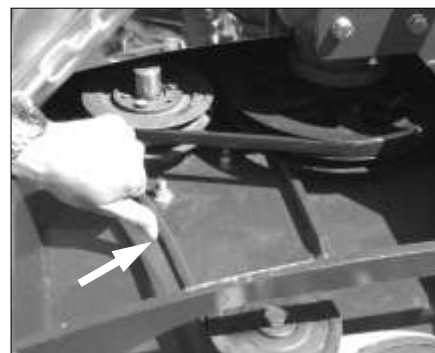
Kontroll av drivremmens spänning
