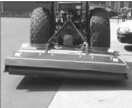
Lyft av klipparen för att se att den lyfts jämnt. Bilden visar att höger sida är för låg.
