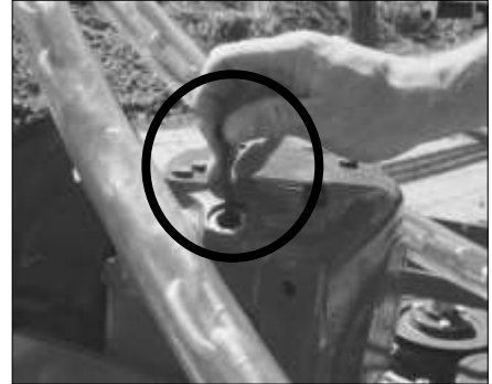
Använda en ren bit tråd som oljesticka
