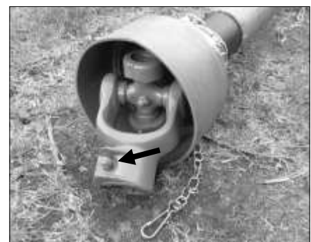
Snabbkopplingar visandes fjäderbelastad låssprint
